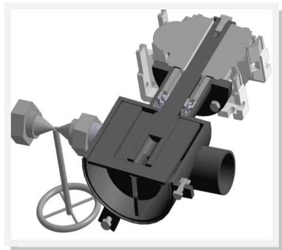
Кожух выдерживает выстрел с пистолета, кожух оснащен гидро компенсаторами, которые позволяют с небольшим усилием поднимать или закрывать кожух.
